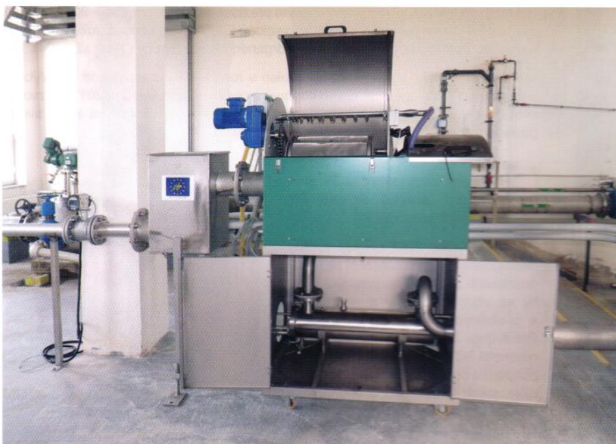
Obr. 1: Pilotní jednotka mikrosíťové filtrace s UV zářením a peroxidem vodíku
